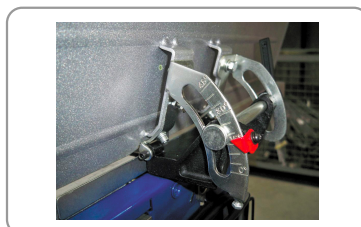
Guide en profilé aluminium inclinable à 45°
