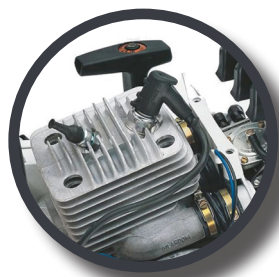
Moteur STIHL à balayage stratifié (4,4 Cv / 3,2 kW)
