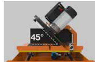
Tête de coupe inclinable jusqu'à 45°
